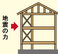
横から力がかかっても倒壊しないだけの強度を持つように設計する。変形の影響は細かく考えない。
